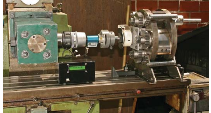
Fig. 5. Montaje del motor para medir las pérdidas por fricción.
