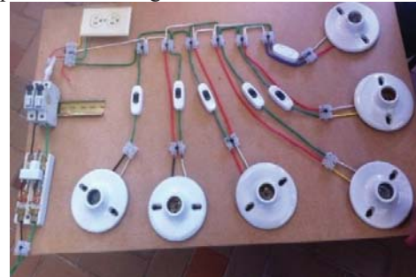
Fig. 1. Circuito desarrollado para la calibración del equipo medidor de la huella de carbono.
