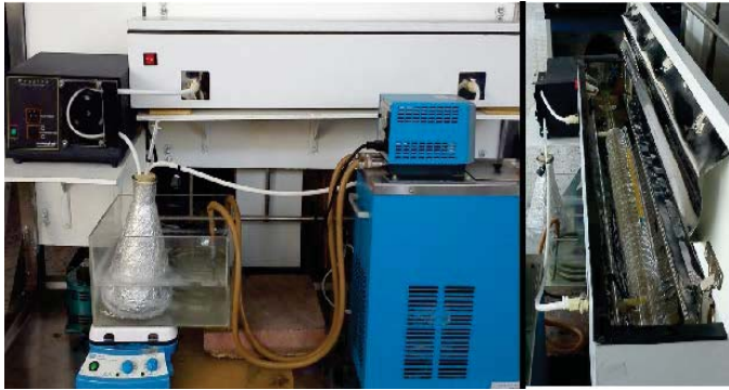
Fig. 2. Sistema de fotodegradación de la solución de 4-Clorofenol (sistema semicontinuo).
